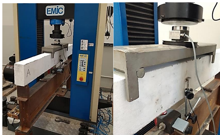
Figura 2. Aspecto geral da montagem do ensaio de flexão a quatro pontos.
