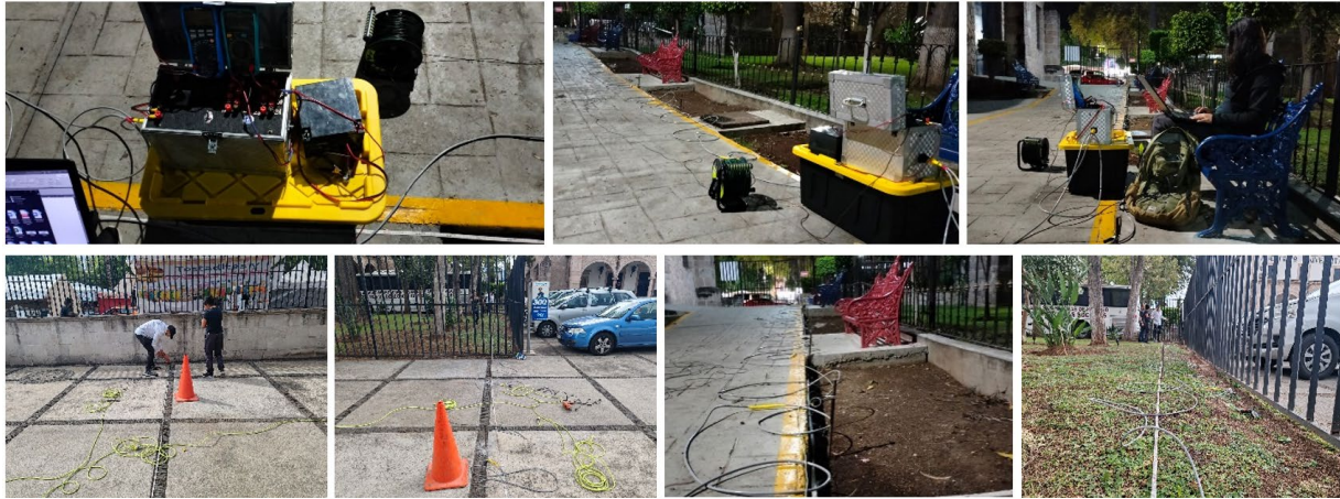
Figura 4. El instrumento de medición es un resistivímetro en corriente continua de la Tomografía Geoeléctrica.
