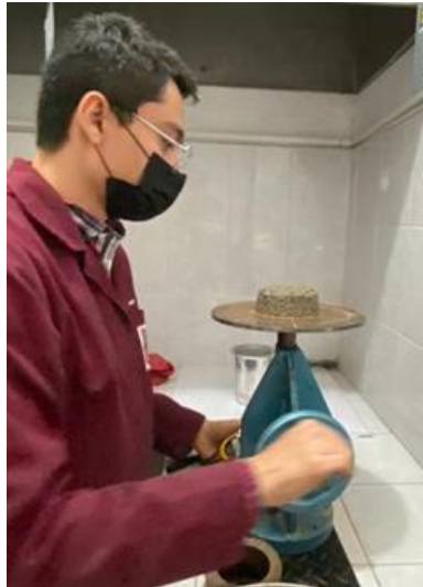
Figura 2.- Detalle de la prueba de fluidez de los morteros.
