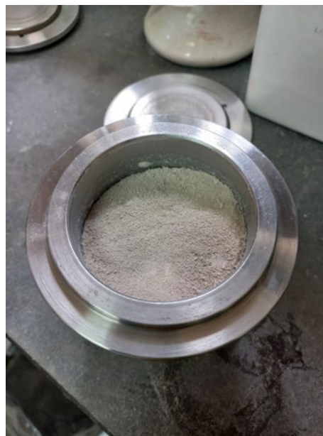
Figura 6. Preparación de material contemporáneo, antes del pulverizado. Por el autor.
