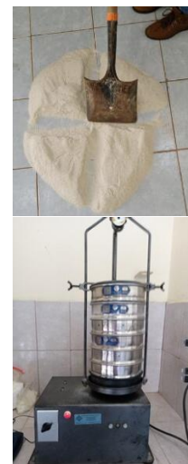
Figura 2. Datos y proceso de la granulometría del PET-reciclado triturado
