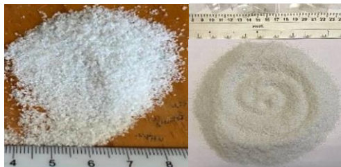
Figura 1. Imagen de las partículas de PET-reciclado triturado
