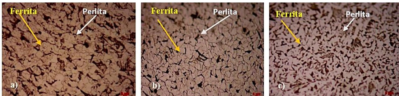
Figura 4. Distribución de las fases ferrita-perlita en los estribos a) EA y b) EFE, así como de la varilla c) VA.
