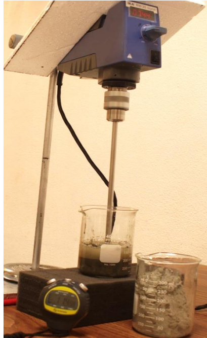
Figura 1. Proceso de mezclado de pasta de cemento
