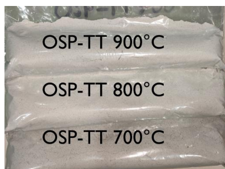
Figura 3. Muestras de OSP tratada térmicamente a 700°C, 800°C y 900°C.
