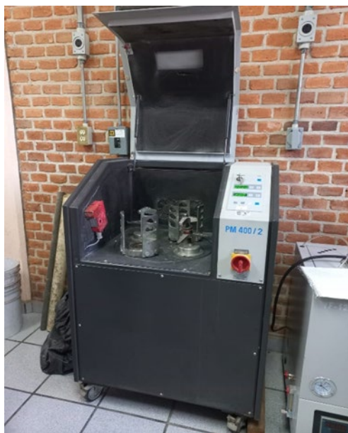
Figura 5. Molino de bolas planetario. Por el autor.
