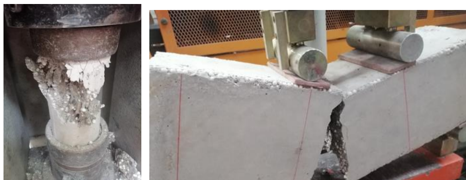
Fotografía 2 Evaluación de resistencia a la compresión y resistencia a la flexión en LWSCC.
