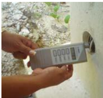
Figura 6. Medición de temperatura y humedad relativa en columna.
