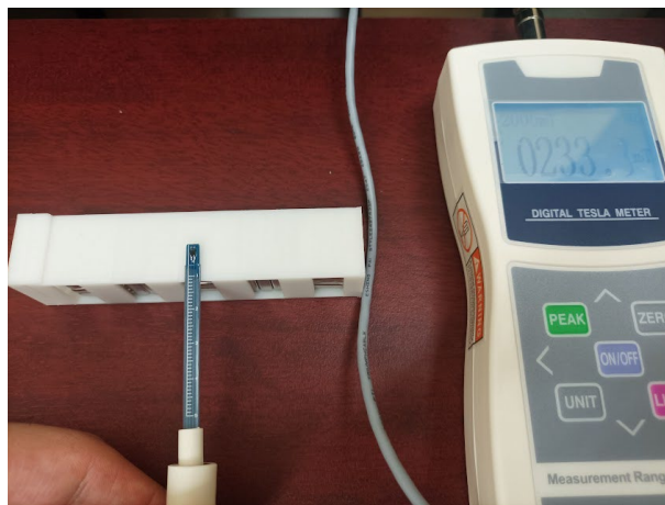
Figura 9. Campo magnético obtenido en el arreglo de Halbach (233 mT), a pesar de que no hay contacto directo con los imanes permanentes.
