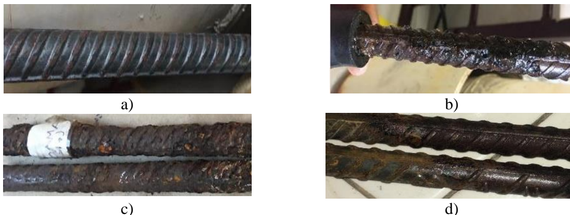
Figura 2. Acero de refuerzo a) VL sin recubrimiento, b) VC, c) VOA y d) VOI con recubrimiento. Los recubrimientos de magnetita se obtuvieron aplicando 1.5 V durante 15 días.
