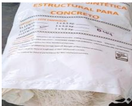
Figura 1. Microfibra sintética para concreto utilizada en el diseño de la mezcla.
