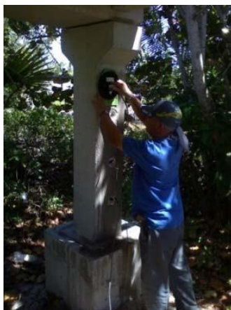
Figura 4.- Proceso de medición con el Gcorr 6.
