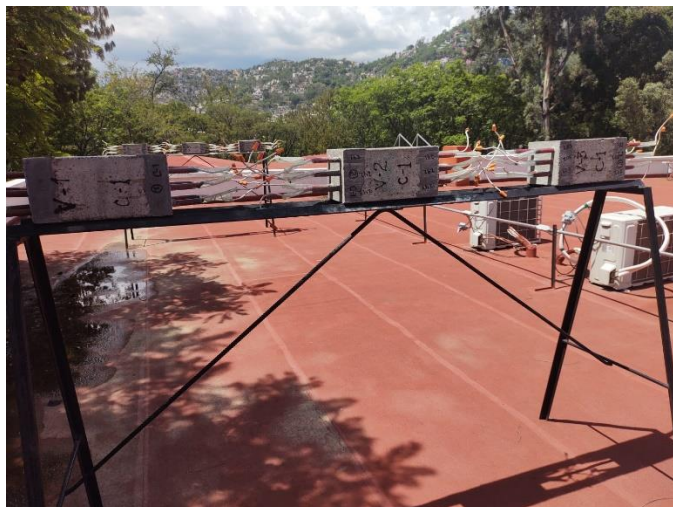
Figura 2. Exposición al medio ambiente de las probetas de concreto reforzado
