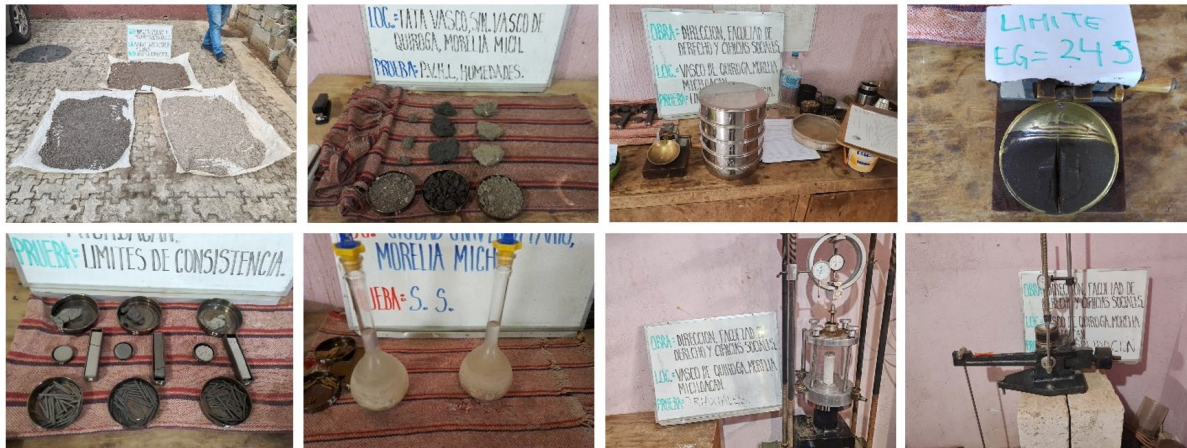
Figura 5. Proceso de realización de las propiedades índice y mecánicas (contenido de agua, granulometrías, límites de consistencia, densidad de sólidos, PVHL, compresión simple, triaxiales, consolidación.).
