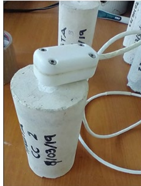
Figura 6. Prueba de pasta de cal con la aguja 60 mm de longitud
