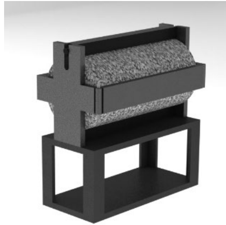
Figura 2: Celda brasileña para ensayo de tracción indirecta
