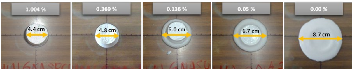
Figura 4. Diámetro de extensibilidad (fluidez) de las pastas de cal hidráulica después de ejecutar la prueba de flujo de asentamiento para las pastas de cemento con relación a/c=1. La concentración del aditivo se expresa en gramos de aditivo seco por cada 100 g de cal (% m/m).
