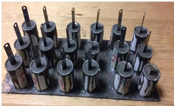
Figura 1. Grietas artificiales en muestras de pastas de cemento Portland. La grieta se formó con los calibradores insertados en cemento fresco para posteriormente extraerlas.
