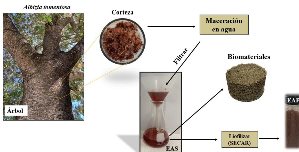
Figura 1. Metodología para la extracción orgánica de la corteza de Albizia tomentosa y la preparación de los morteros de cemento con el aditivo orgánico.
