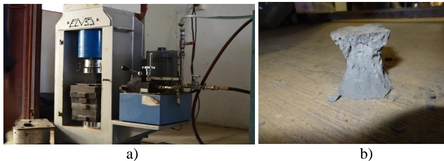
Figura 3. Prensa hidráulica ELVEC E659-5, utilizada para la prueba de resistencia a la compresión.
