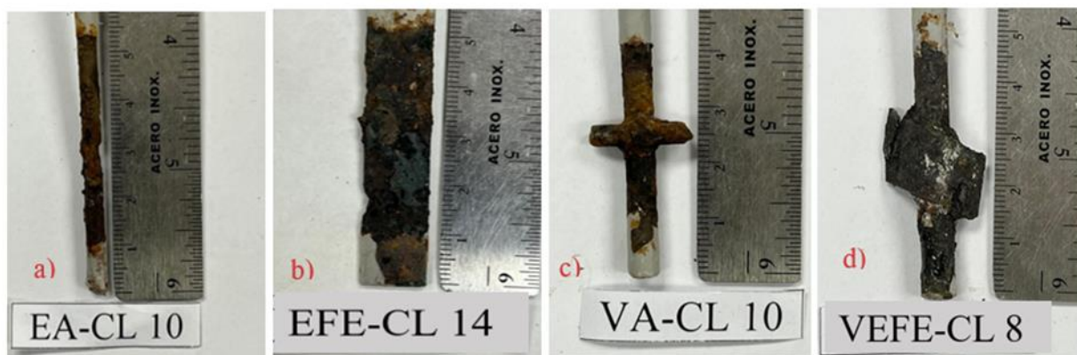
Figura 11. Deterioro en especímenes de acero embebidos en concreto, con el diseño de mezcla, con cloruros, durante la etapa de propagación de la corrosión: a) serie EA- CL, b) serie EFE-CL, c) serie VA-CL, d) serie VEFE-CL.
