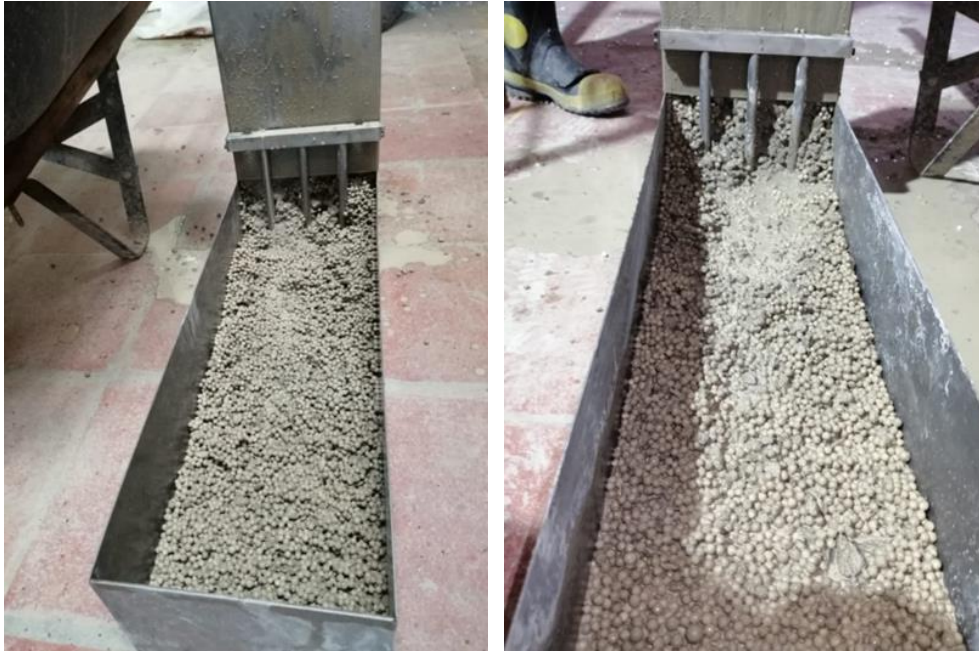
Fotografía 1 Ensayo de Caja L en LWSCC
