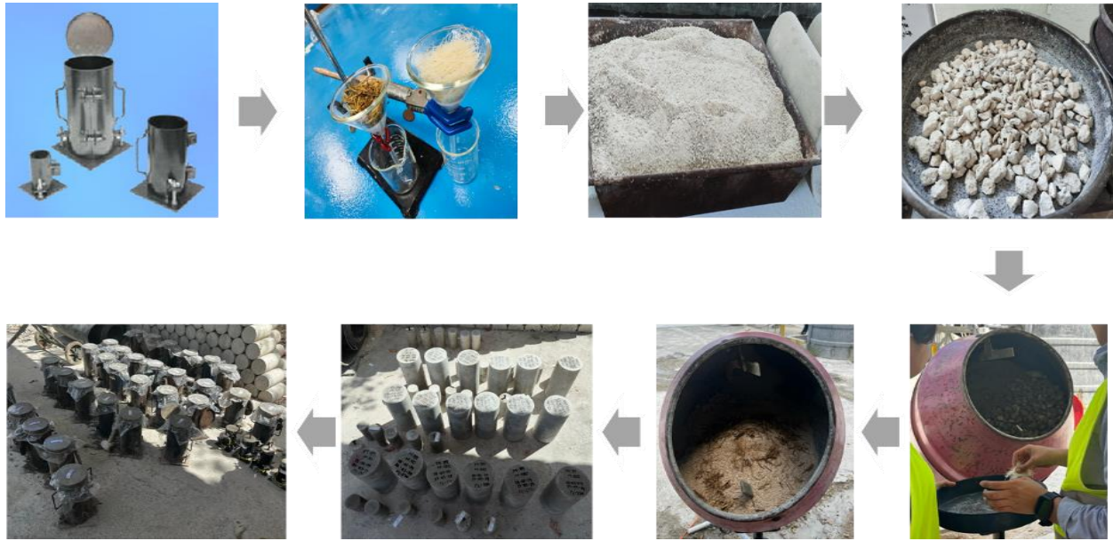
Figura 1. Proceso de elaboración de las probetas de concreto convencional y con adiciones de fibras de henequén y bagazo de caña de azúcar.
