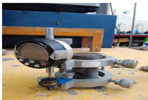
Figura 2. Probeta y micrómetro de carátula para la determinación del módulo de elasticidad estático.
