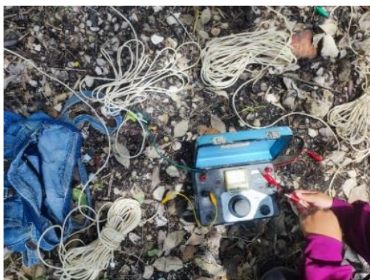
Figura 4. Lectura de resistividad del suelo.
