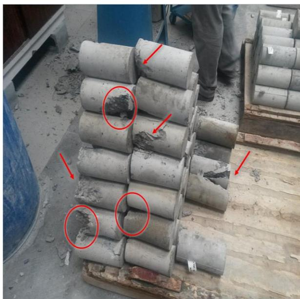
Figura 5. Ruptura no topo por erro de ensaio.
