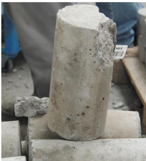
Figura 4. Ruptura no topo por erro de ensaio.
