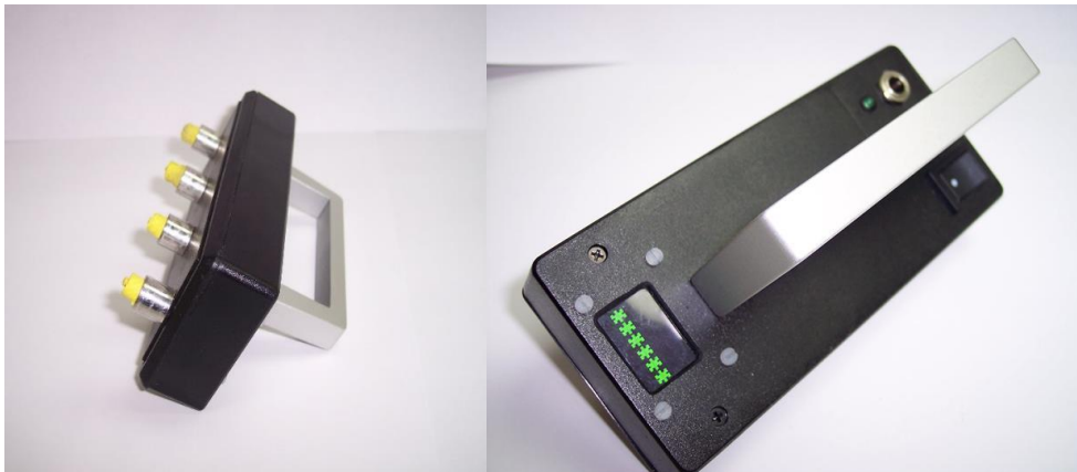
Figura 3. Resistivímetro con 4 puntas que tiene esponjas en sus extremos para facilitar el contacto electrolítico con el hormigón.
