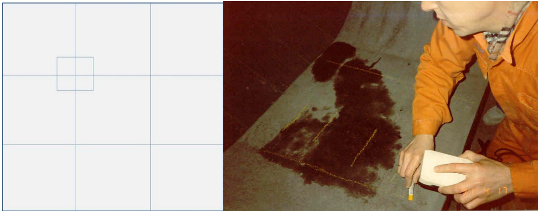
Figura 5. Trazado de una cuadrícula regular sobre el hormigón para el mapeo de la estructura.
