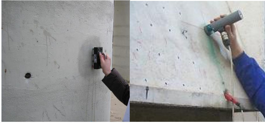
Figura 7. Agua abundante para mojado superficial y dibujado de cuadrícula para las medidas
